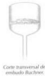
Corte transversal del embudo Buchner.
