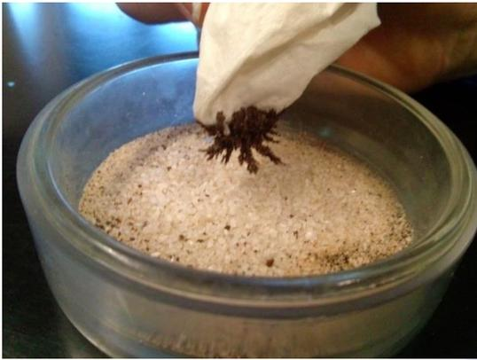
3. En segundo lugar con todo el material sólido que hemos recogido lo extendemos en el cristizador y lo dejamos secar 10 min. Cuando esté seco, vamos a realizar una SEPARACION MAGNETICA con el imán por debajo podremos separar la parte que sea imantada. Es muy importante que el imán este envuelto en un trozo de plástico y no se manche de líquido. ¿Que ocurre? ¿Cómo están dispuestas las limaduras?
